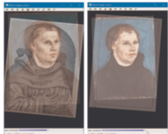
Abb: 3: Registrierung anhand von Gesichtsmerkmalen: Ergebnisse des Face Detectors und des Facial Landmark Detectors ArtFacePoints und der Registrierung. Bildquellen: Werkstatt Lucas Cranach d. Ä., Martin Luther, Stiftung August Ohm, Hamburg (III.M-Sup01) Lucas Cranach d. Ä., Martin Luther als Augustinermönch im Ordenshabit in Nische (gespiegelt), Exemplar der Klassik Stiftung Weimar (I.2D1) Durchzeichnung des Werks: Lucas Cranach d. Ä., Martin Luther, Kunstsammlungen der Veste Coburg (IV.M2a)
