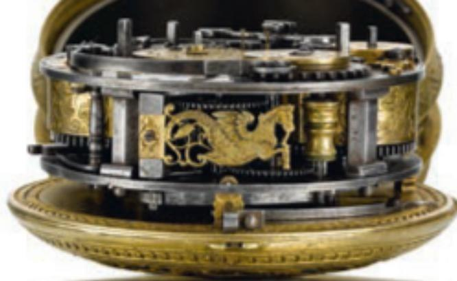
RECHTS OBEN. Durchbrochener Deckel mit Mischwesen aus Pferd und Drache auf der Werkseite. In geschlossenem Zustand ist die Glocke durch die Säulen an der Gehäuseflanke sichtbar.
