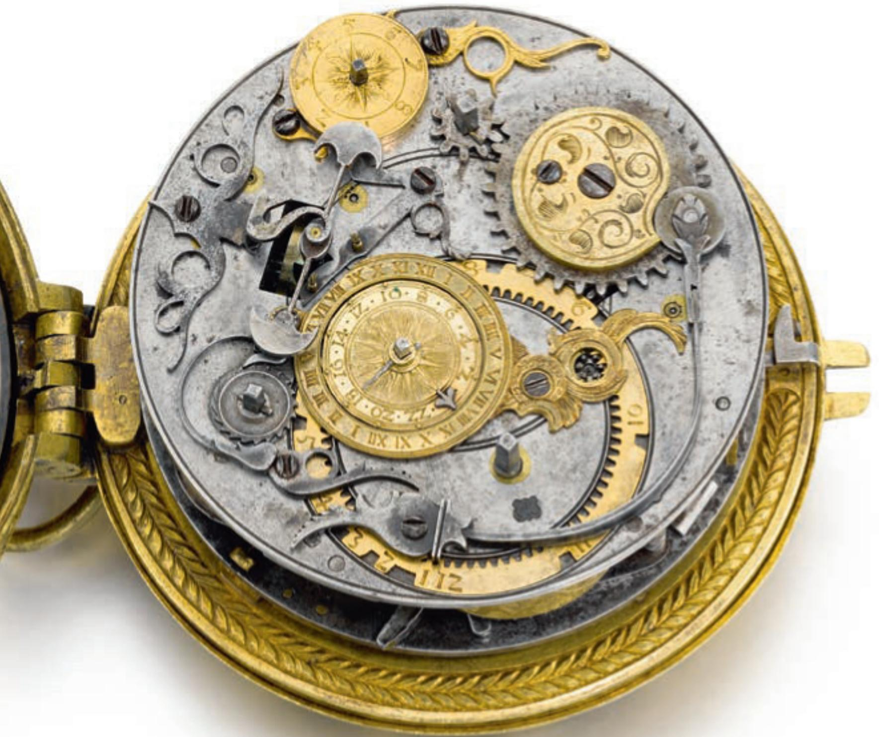
LINKS. Bodenplatte des Werks. Die Weckzeit wird über die versetzten zentralen Scheiben eingestellt. Der große eingelassene, vergoldete Ring ist die Schlossteife für den Stundenschlag. Die Kurvenscheibe des Stackfreeds mit Feder und Rolle ist oben rechts zu erkennen. Die mit 1-8 markierte Scheibe bewegt den Arm der Schweinsborstenregulierung.
