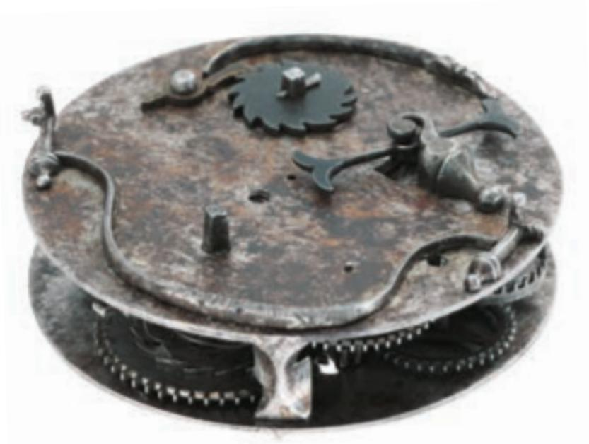
OBEN. Werkbodenplatte mit der Aufzugswelle links unten. Das Foliot (das wie eine Unruh funktioniert) hat T-förmige Enden.
